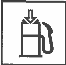
Depósito de combustible remoto
