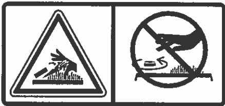
Fluido caliente presurizado
