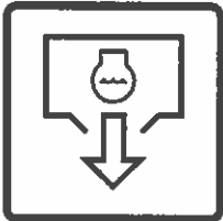
Drenaje de refrigerante
